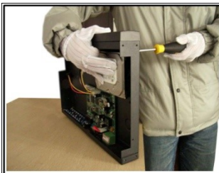
3. ábra HDD becsavarozása
