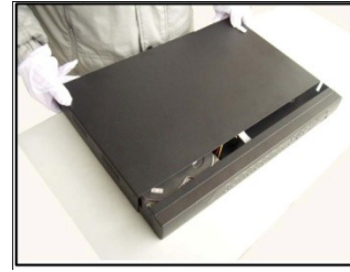
7. ábra Fedlap visszahelyezése
